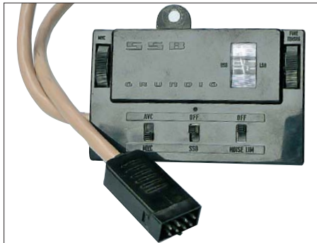
Bild 10: Der berühmte ansteckbare BFO für die Satelliten der ersten Generationen
