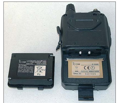
Bild 3: Der Li-Ion-Akkumulator hat die beachtliche Kapazität von 1,5 Ah bei 7,4 V.
