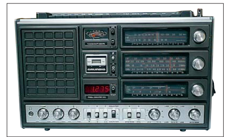
Bild 12: Riesig im Wortsinn; der Satellit 3000 maß 520 mm und war der erste mit zuschaltbarer digitaler Frequenzanzeige.
