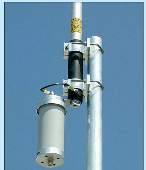
Bild 60: Einspeisung der Breitband-Groundplane-Antenne BB-7V; unten ist der Balun (MTFT) zu erkennen. Fotos: WiMo
