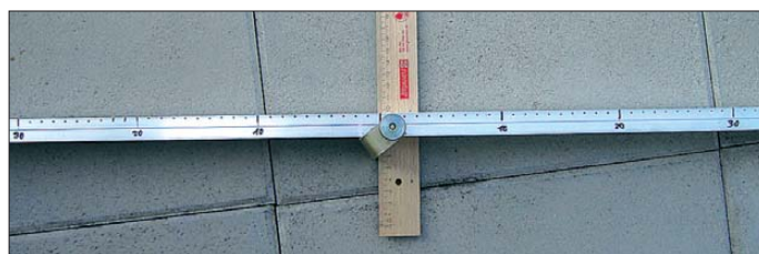
Bild 5: Auf den mit einem Filzschreiber eingetragenen Durchmesser ist die Folie als Reflektor zu kleben.
