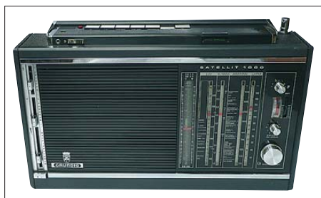
Bild 5: Neue Optik, 17 extrem gespreizte KW-Bänder, ansonsten folgte der Satellit 1000 der technischen Linie seiner Vorgänger.
