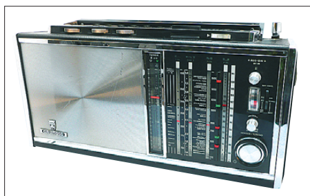
Bild 4: Der zweite Satellit, der 208, ist ein Doppelsuperhet mit FET-Tuner. Dieses Exemplar wartet noch auf die optische Restaurierung.
