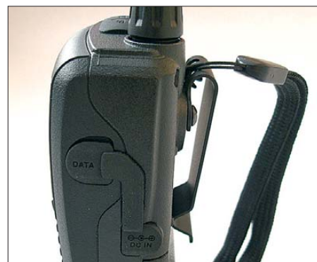
Bild 12: Der Gürtelclip aus Metall sitzt sehr straff, die Handschlaufe wird an ihm eingefädelt. Fotos: DG1NEJ
