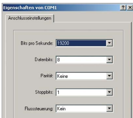
Bild 6: Diese Schnittstellenparameter sind für die Initialkonfiguration des Bluetooth-Moduls im Terminalprogramm zu wählen.
