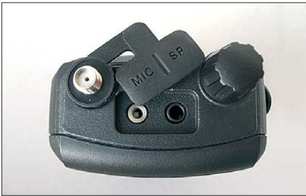
Bild 5: Der Mikrofonanschluss auf der Oberseite entspricht dem gewohnten Icom-Standard, für die Antenne gibt es eine SMA-Buchse.
