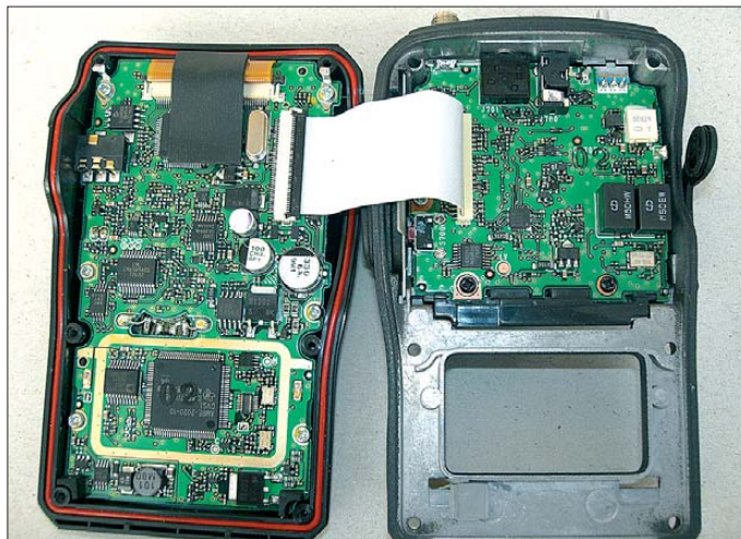
Bild 10: Der Blick ins Innere zeigt rechts die zwei ZF-Filter für NFM und NFM schmal.
