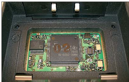
Bild 9: Geheimnis im Akkumulatorfach: Unter einer Blechabdeckung liegt die DV-Einheit mit einer offenen Buchsenleiste.
